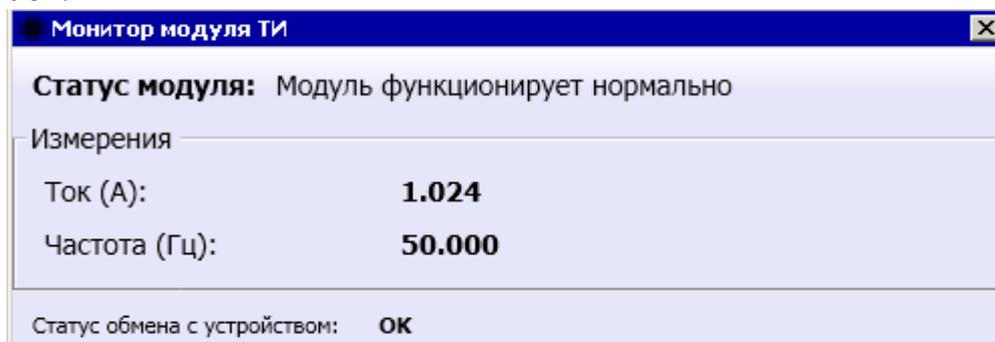
Рисунок 31. Окно монитора модуля ТИ.
